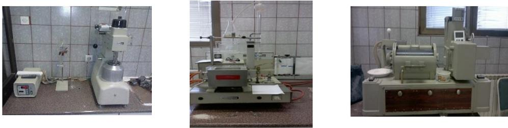
**Fig. 2. Amylograph Brabender, farinograph Brabender Duisburg and extensograph Brabender**
