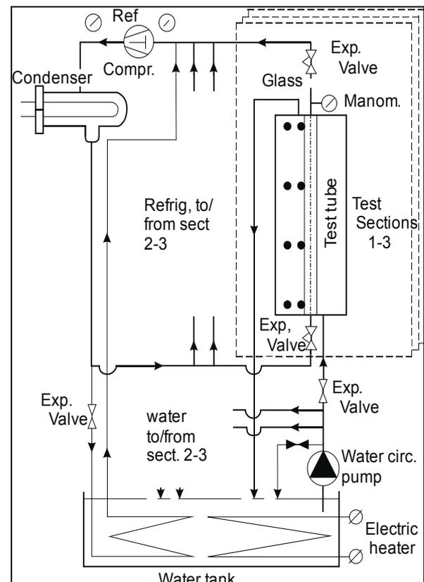
Fig. 2. Experimental rig
